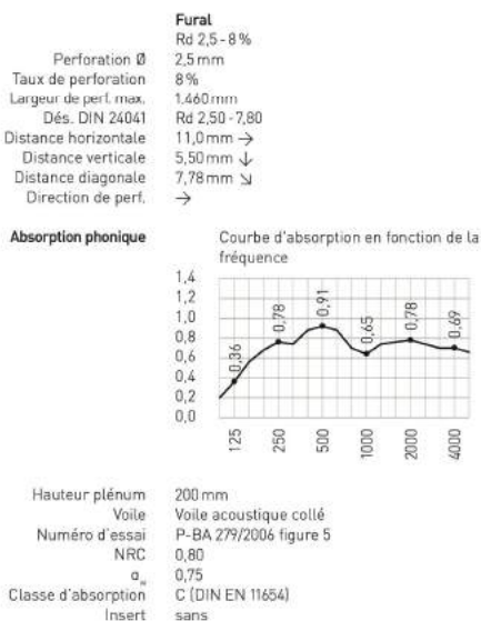
Image 25 : Exemple de performance d'un plafond perforé avec plénum de 200mm, avec voile acoustique collé, différentes perforations, sans absorbant complémentaire - source www.fural.com
