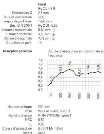
Image 25 : Exemple de performance d'un plafond perforé avec plénum de 200mm, avec voile acoustique collé, différentes perforations, sans absorbant complémentaire - source www.fural.com
