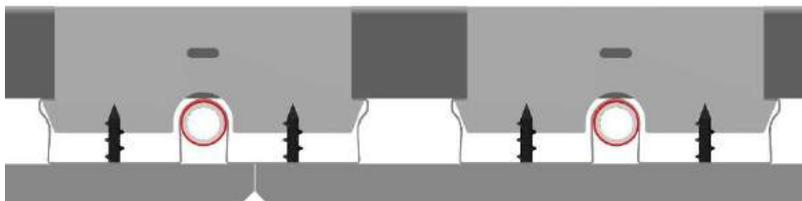
Disposez le joint de la plaque en plâtre / ciment sur le profilé Klimatop.
